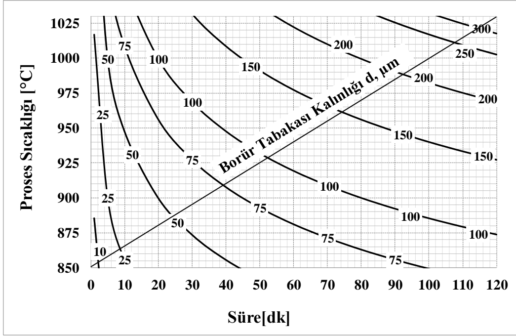
Şekil 5.11 : Düşük alaşımlı çeliklerin elektrokimyasal borlanmasında uygulanan sıcaklık ve elektroliz süresine bağlı olarak toplam borür tabakasının kalınlık değişimi [200 mA/cm 2 ve %90Boraks + %10Na 2 CO 3 ].
