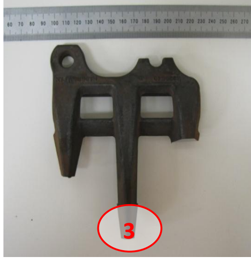
Şekil 5.35 : Karbürlenmiş, EB ve FH işleme tabi tutulmuş ve sonrasında su verilmiş tarım parçasının makro görünümü.
